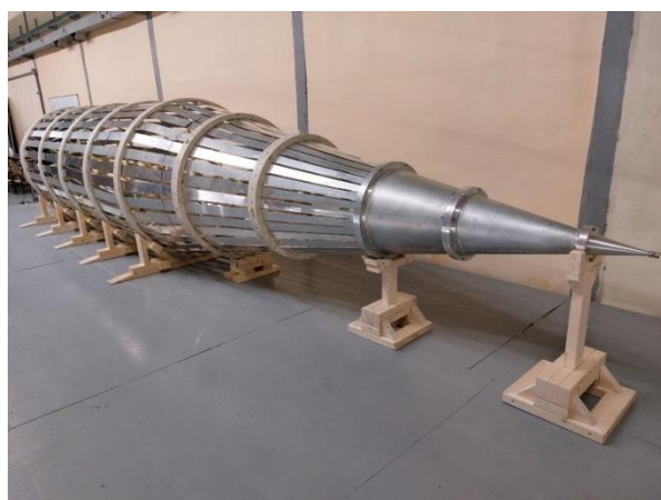
Рис.1. Фотография крупномасштабной коаксиальной линии (слева); фотографии свечения воздуха в передающей линии при прохождении мощных ЭМИ в зависимости от давления и периода повторения импульсов (справа).
